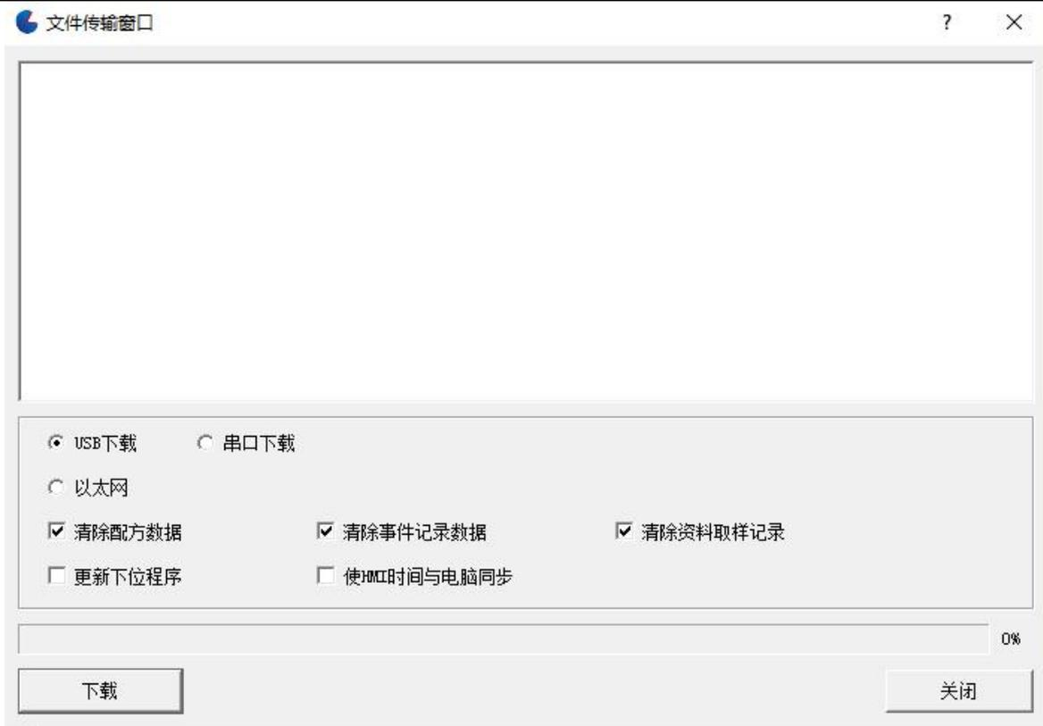
**选择“USB 下载”：**需要将触摸屏和电脑以 USB 方式连接，并且保证已正确安装触摸屏驱动。
