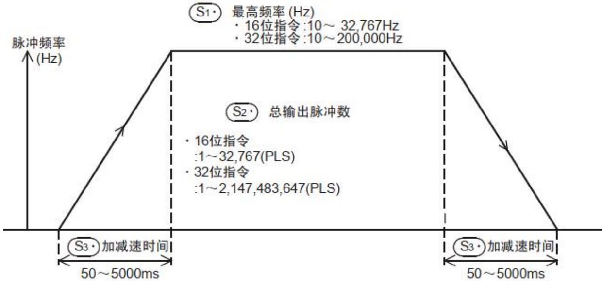
**指令介绍:** 从输出 Y [D.] 中输出脉冲，其最高频率 S1.，执行 S3. ms 时间的减减速，输出脉冲数仅为 S2.。
