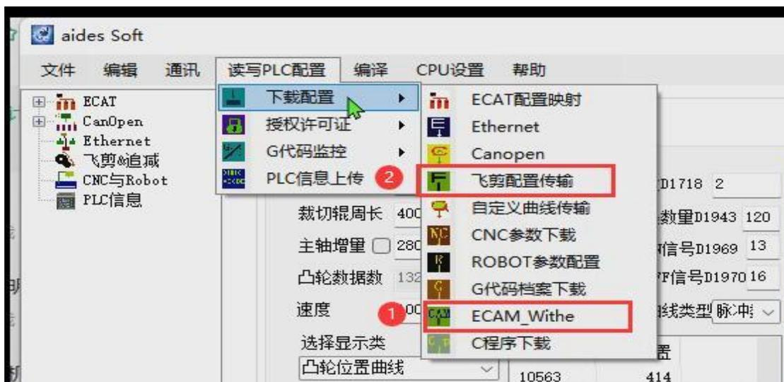
建议按顺序下载配置，先下载 ECAM\_Withe，后下载飞剪配置传输。
